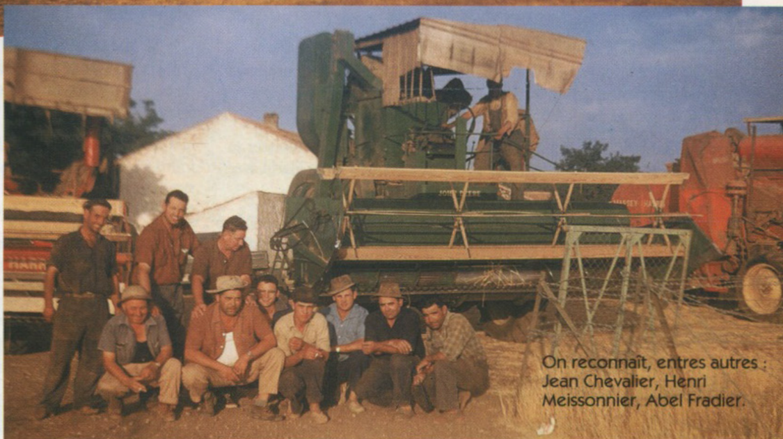
La batteuse sert maintenant de trieur à haut débit pour bien nettoyer le blé et augmenter son P.S.
